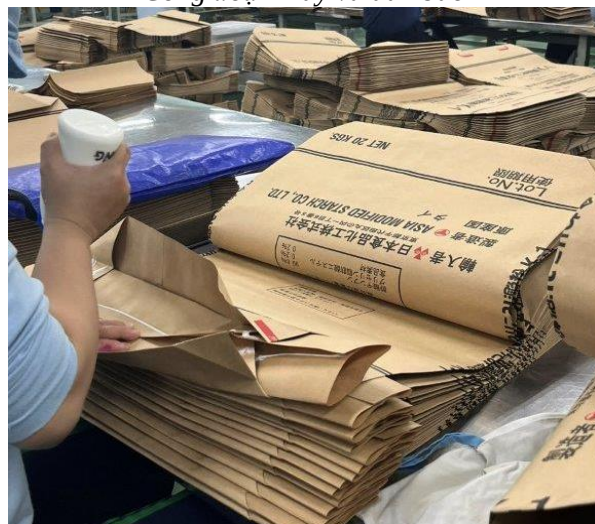
Công đoạn dán bao, dán tape
