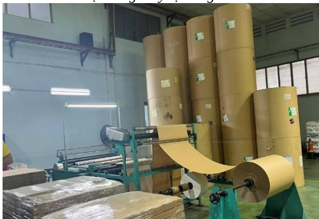
Công đoạn cắt tấm
